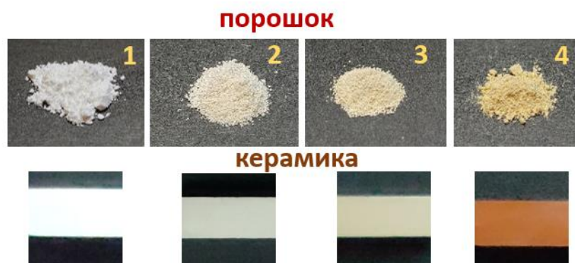
Рисунок 3.37 – Образцы порошковых материалов и керамик, где 1 – ATZ без добавки, 2 – ATZ-0,33Fe, 3 – ATZ-1Fe, 4 – ATZ-3Fe
