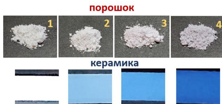
Рисунок 3.52 – Образцы порошковых материалов и керамик, где 1 – 5ATZ без добавки, 2 – 5ATZ-0,33Co, 3 – 5ATZ-1Co, 4 – 5ATZ-3Co
