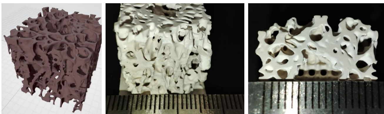
Рисунок 3.26 – Компьютерная 3D-модель (а); цифровые фотографии сырца (б, в) фрагмента костной ткани с ценой деления 1 мм
